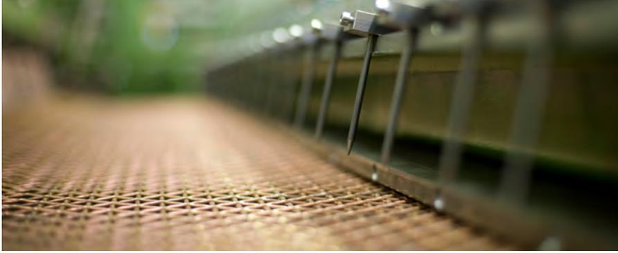
Gitterwebmaschine für Drahtsiebböden
