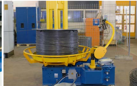
Размотчик с компенсаторным рычагом
