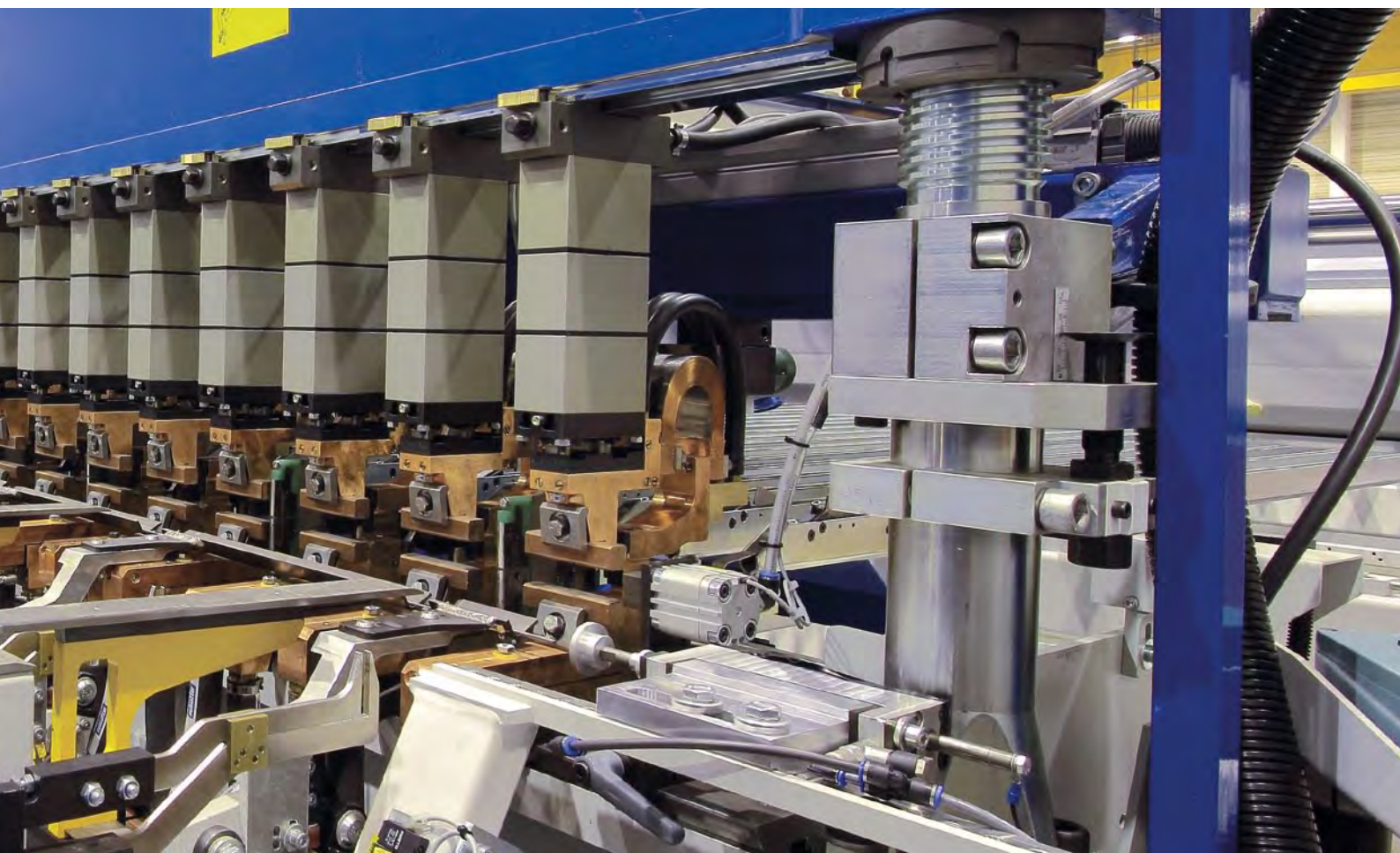
Система MG700 с поперечной подачей проволоки сверху и снизу
