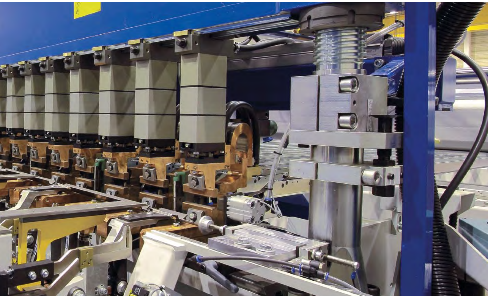
Système MG700 avec alimentation de fil transversal par le dessus et le dessous
