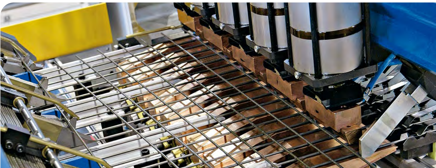
Portique de soudage avec extracteur linéaire
