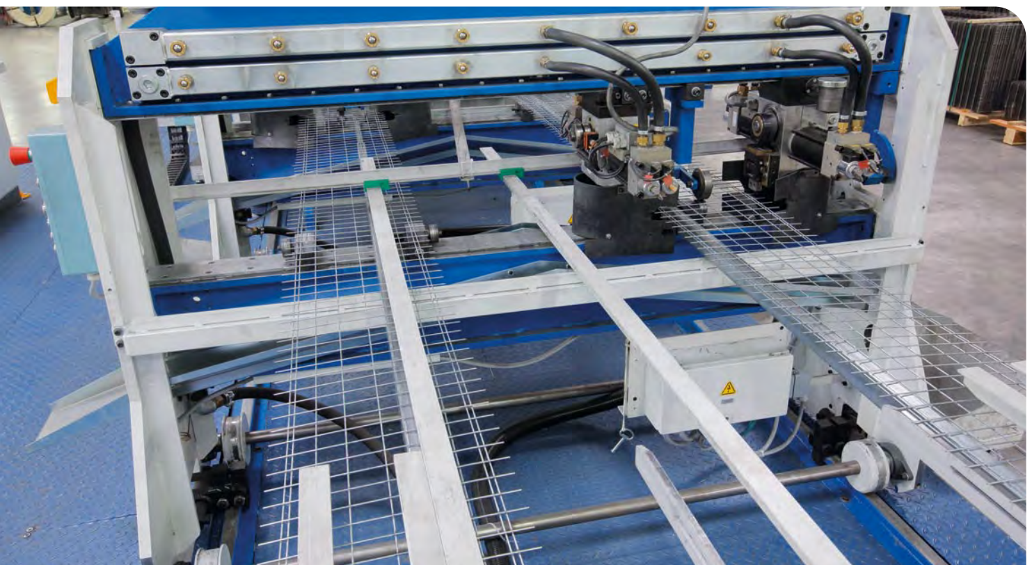
Système MG600 pour la production de treillis pour cages
