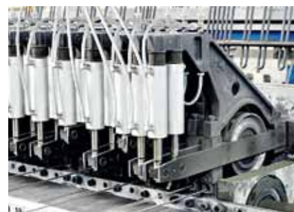
Устройство роликовой подачи продольной проволоки Устройство роликовой подачи предназначено для подачи продольной проволоки и производства поперечной ячейки, поперечная ячейка свободно программируется
