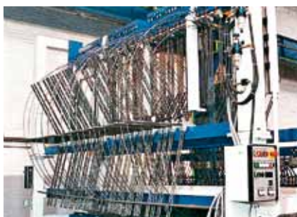
Устройство для вытягивания и компенсации продольной проволоки Каждая проволока контролируется индивидуально
