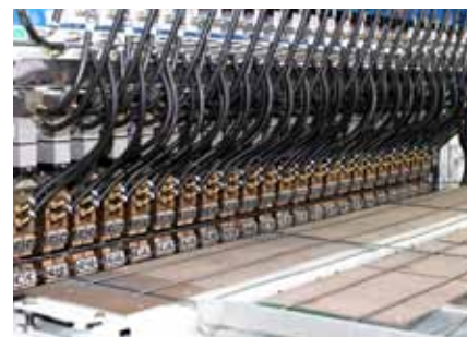
Сварочный портал MG316d Нет необходимости в переналадке благодаря единичным сварочным группам в растре 50 мм
