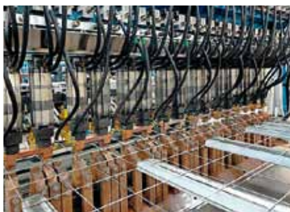
Сварочный портал для MG303 и MG316e С пневматическими мягко действующими высокоэффективными сварочными прессами и кубическими электродами
