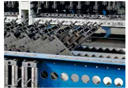
Tiro y enderezado de alambres longitudinales Unidad enderezadora en dos niveles con regulación central
