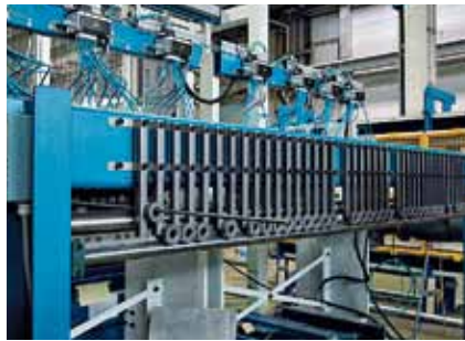
Control de alambre longitudinal El dispositivo controla los alambres longitudinales y detiene la planta si se rompe el alambre o se llega al fin de éste
