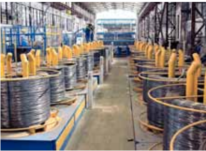
Portacarretes de alambre longitudinal Horizontal o vertical desde carrete o bobina
