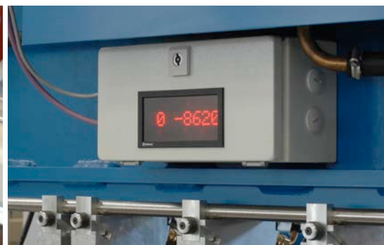
Дисплей для отображения позиции направляющей продольного стержня
