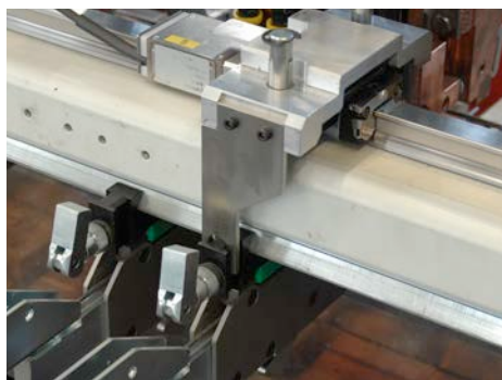
Измерительная система для позиционирования направляющих продольных стержней
