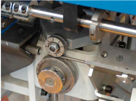
Подача поперечного стержня снизу
