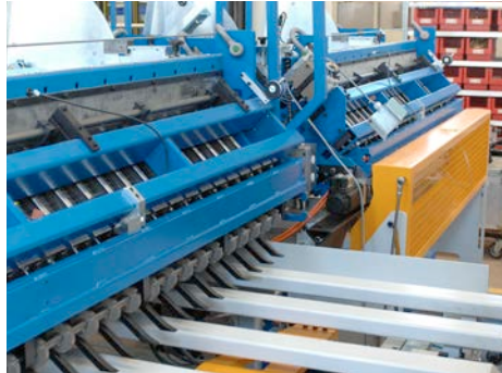
Питатели поперечных стержней сверху и снизу
