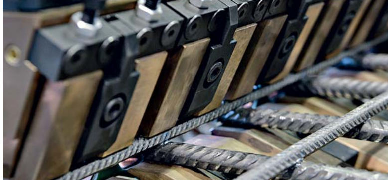
Сварка продольных и поперечных стержней тяжелых сеток
