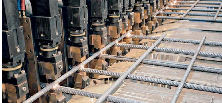
Сварка продольных и поперечных стержней тяжелых сеток
