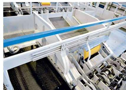
Двойной магазин поперечных стержней Для применения стержней двух различных диаметров в одной арматурной сетке
