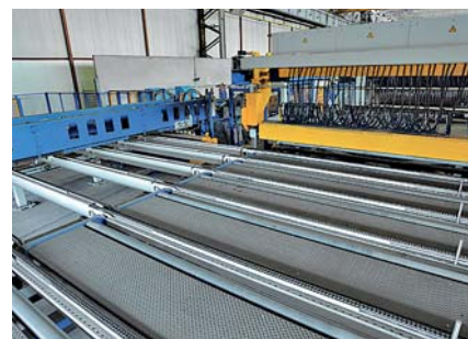
Цепной стол для продольных стержней Для поперечного перемещения стержней
