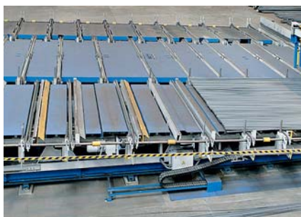
Вибрационный стол для продольных стержней Для распределения пучков стержней
