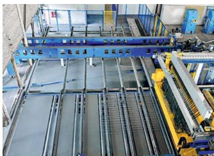
Устройство для точного позиционирования продольных стержней Непосредственно с размотчика, с возможностью установки правильно-отрезного станка Syrocut
