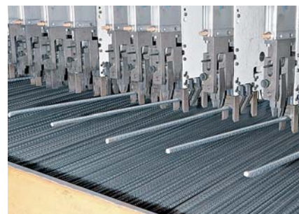
Устройство захвата продольных стержней Для автоматической загрузки
