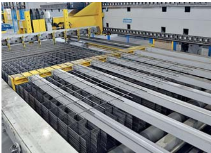
Empileur de panneaux Pour l'empilage de panneaux légers et lourds; l'empilage précis permet un traitement ultérieur automatique si nécessaire
