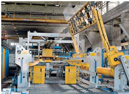
Empileur-retourneur automatique de panneaux Afin d'économiser les frais de transport, les panneaux sont en partie retournés et empilés, afin de gagner de l'espace et d'optimiser le transport
