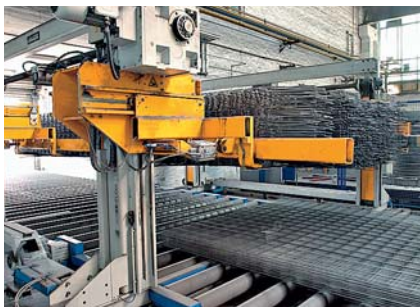
Empileur de paquets de panneaux L'empileur de paquets de panneaux permet d'accélérer et d'automatiser la logistique à la fin du processus de production
