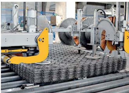
Ligatureuse automatique Elle permet de ligaturer automatiquement les piles de panneaux, pour une meilleure rentabilité du processus de production
