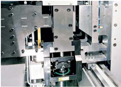
Cisaille individuelle pour fils de chaîne Pour la production rentable de treillis d'armature plus courts
