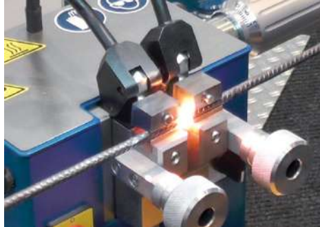
Стыковая сварка с постоянным высоким качеством
