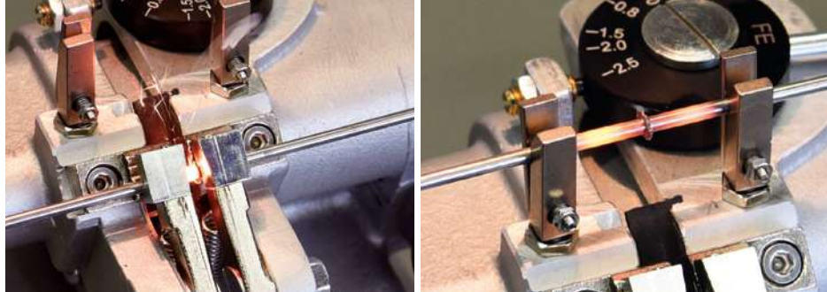
Procédé de soudage pour diamètre de fil 2.5 mm
