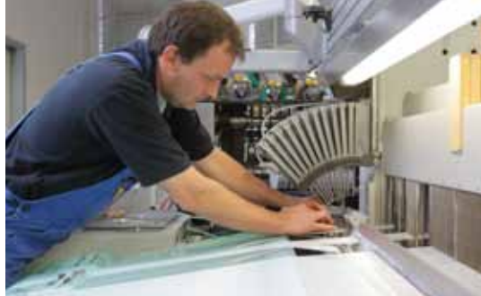
Широкоформатный ткацкий станок для производства сит бумагоделательных машин.
