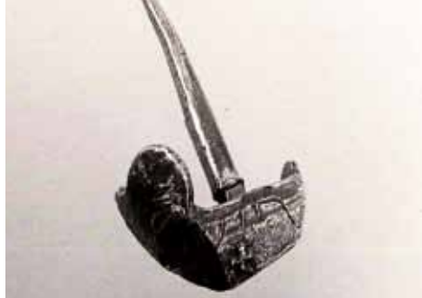
Обувной гвоздь, сформованный и сваренный с использованием электротермии
