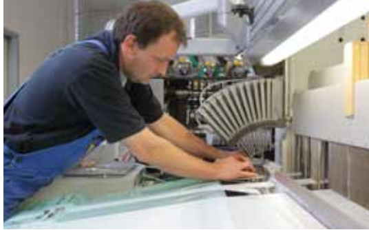
Métier à tisser grande largeur pour la fabrication d'habilages de machines à papier
