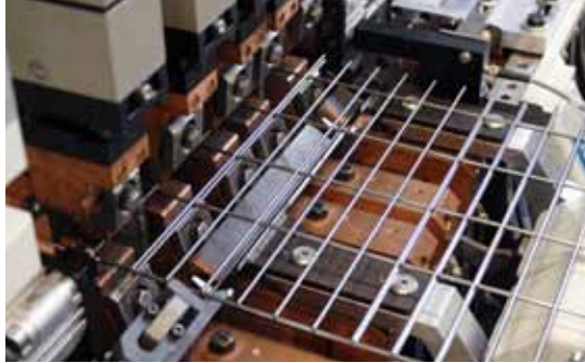
Treillis avec double fils de trame soudés
