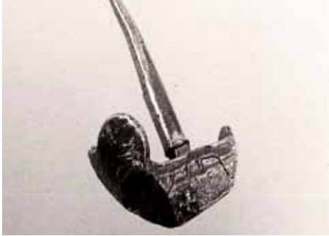
Caboche, formée et soudée par résistance
