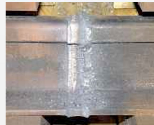
Schweißen von verschiedensten Legierungen, inklusive Manganstahl mit Chromstahleinsatz
