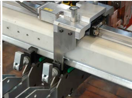
Sistema de medición para el posicionamiento de las guías de alambre longitudinal
