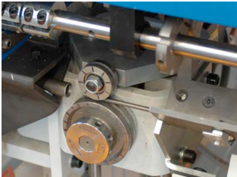
Injection du fil transversal inférieur
