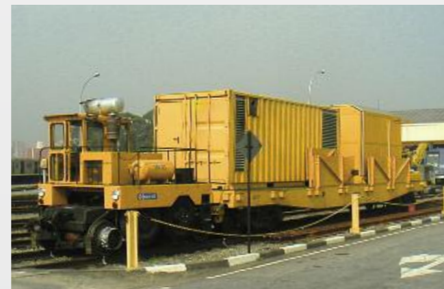
Supra multi flex mit AMS60 in Container eingebaut und auf Eisenbahnwaggon montiert. Schweisseinsatz im Depot.
