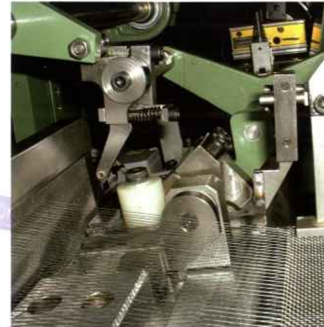
Schussdrahtschneid- und Klemmeinrichtung / Weft wire cutting and clamping device
