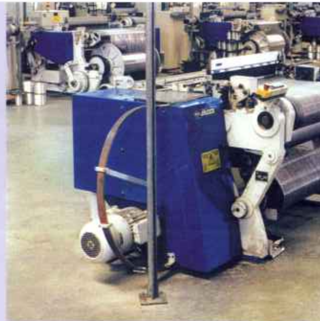
Drahtwebmaschine BD 100 für die Herstellung von Moskitogeweben / Wire weaving machine BD 100 for the production of mosquito fabrics
