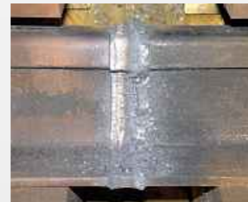
Soudage des alliages les plus divers, y compris l'acier au manganèse avec insert en acier chromé
